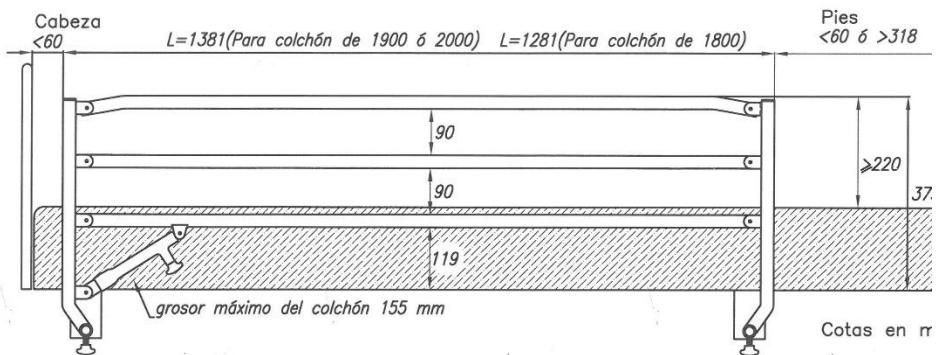
Estructura de acero con tres barras de tubo Ø25x1.5mm. y columnas de acero. Sin asa.
