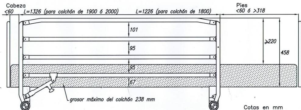
Estructura de acero con cuatro barras de tubo Ø25x1.5mm. y columnas de plástico termoinyectado con 15%FV. Sin asa.
